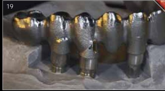
Abb. 18 und 19 Das nach dem Laser- melting-Verfahren in Schweden produzier- te Gefüst passt abso- lut spannungsfrei auf das Modell
